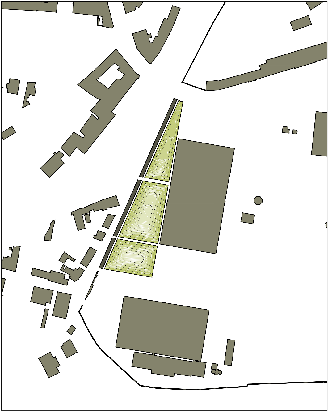
06. VYMEZENÍ SPORTOVIŠŤ - klín mezi domem- plotem a sportovní halou bude patřit sportům všeho druhu, jednotlivá odvětví jsou od sebe oddělena sítí příčných stezek na tři palouky, které těsně přimykají k novostavbě se zázemím
